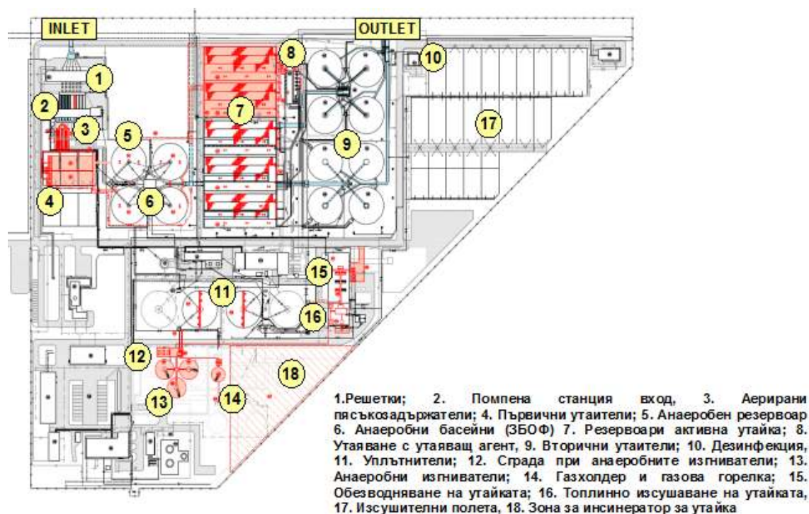
Фигура 21. План на ПСОВ – Пловдив след реконструкция и разширение
